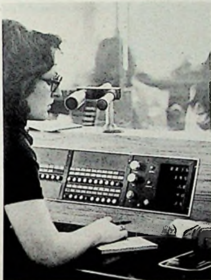
De meldingstafel van het systeem „Teledat”, waarop links duidelijk de indicatielampjes zichtbaar zijn. Rechts bevindt zich het scherm, waarop de kentekens van de laatste vijf taxi's, waarmee radiocontact is geweest, staan vermeld.
